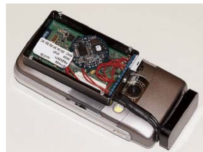
Bild 4: Nokia 6830 mit BtNode-RFID-Lesegerät und externer Antenne
