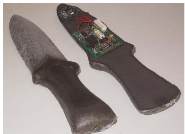
Bild 6: BTnode-Modul mit RFID-Lesegerät integriert in ein Spielzeugschwert
