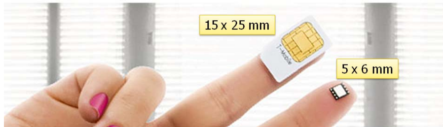
Bild 6: Mini-SIM-Karte und embedded SIM.
