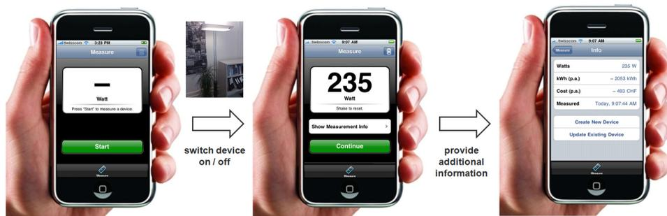
**Abbildung 5.** Messansicht (iPhone-Version). Ein Drücken des Startknopfs initialisiert die Messfunktion. Durch anschließendes Ein- / Ausschalten des Geräts wird der Verbrauch ermittelt. Danach kann die Messung zusammen mit weiteren Details im Geräteinventar gespeichert werden.
