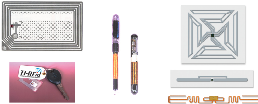
Abb. 2. RFID-Transponder in verschiedenen Bauformen (Quellen: Infineon, TI, Symbol, Alien)
