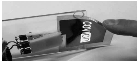
Abb. 6. Ein flexibles Plastik-Display
