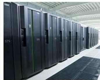
IBM Power 6 "Blizzard" , März 2009 - Okt. 2015: 8448 Prozessoren; 158 TFLOPS; 20 TB
