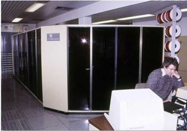
Cyber-205 , bis März 1989: 1 Prozessor; 0.2 GFLOPS; 0.032 GB Hauptspeicher
