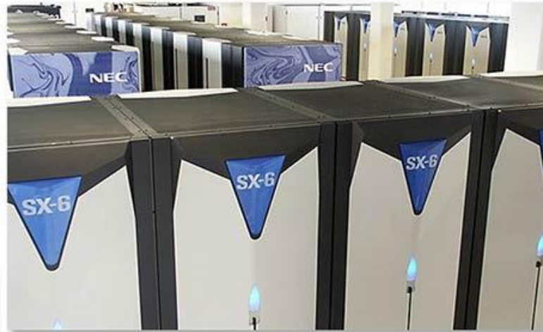
NEC SX-6 , März 2002 - April 2009: 192 Prozessoren; 1.5 TFLOPS; 1.5 TB Hauptspeicher
