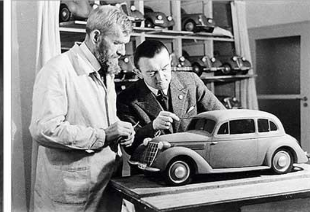
Auto Union in den 1930er-Jahren: Modelleur und Technikvorstand an einem Tonmodell
