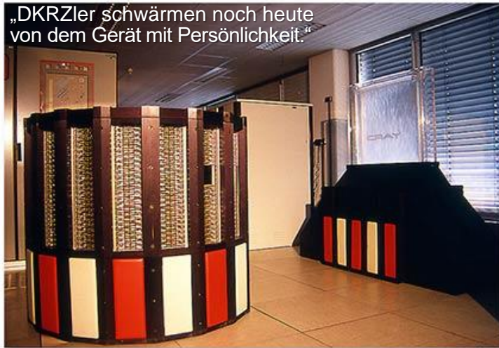
Cray 2S , Nov. 1988 - Mai 1994: 4 Prozessoren; 2 GFLOPS; 1 GB Hauptspeicher
