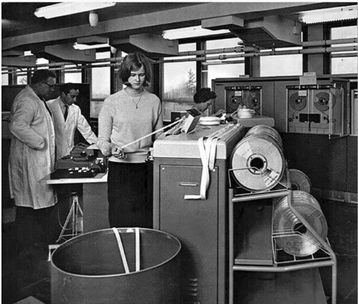
Datenverarbeitung im britischen Met-Office der 1960er-Jahre: Lochkarten, Lochstreifen, Magnetbänder sowie ein Plotter.
