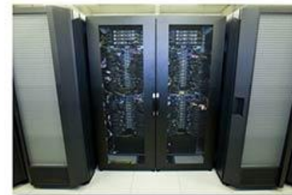
IBM Power 6 "Blizzard" , März 2009 - Okt. 2015: 8448 Prozessoren; 158 TFLOPS; 20 TB
