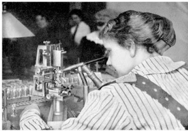
Biegen, Aufsetzen und Schweißen der Elektroden
