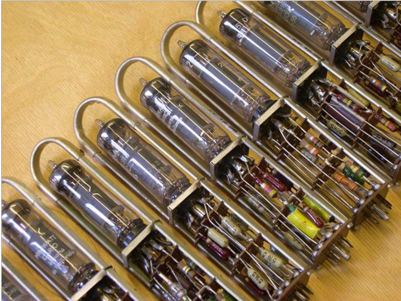
Steckmodule mit Elektronenröhren aus einem IBM-Mainframe der 1950er-Jahre
