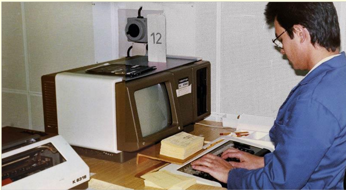
Erfassen von Karteikartendaten für die elektronische Datenverarbeitung in der Abt. XII ; hier ein Robotron A5120-Bürocomputer (8-Bit-Prozessor sowie 8-Zoll-Disketten). Bild aus einer MfS-Fotoserie für das Traditionskabinett der Abteilung XII / Zentralarchiv. Bild: BStU (MfS, Abt. XII, Fo 93, Bild 5)
