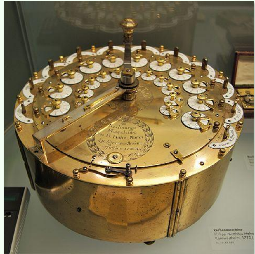
Die „Rechnungsmaschine“ von P. M. Hahn mit 11 Stellen, Durchmesser 26.5 cm, Höhe 11 cm; die Staffeln stehen senkrecht im Kreis [Bild: Wikipedia]
