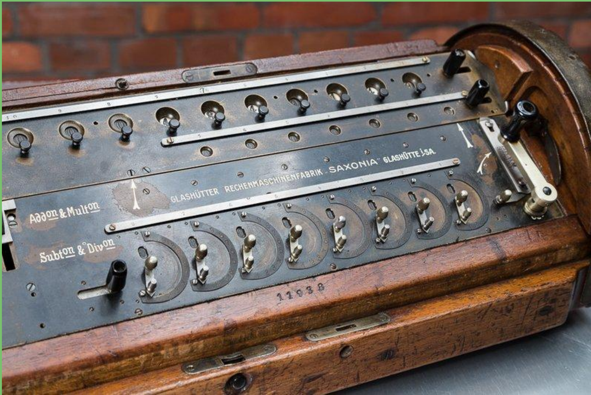
4-Spezies Saxonia-Rechenmaschine von 1895 aus Glashütte. Sie konnte mit einem halbkreisförmig über ausklappbare Seitenscharniere geführten Roldeckel verschlossen werden und sah dann aus wie ein Brotkasten. [web.saechsisches-industriemuseum.com]
