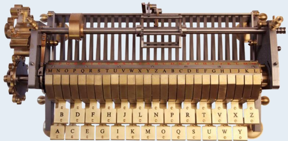
Über den 26 Buchstabentasten die Anzeigewalze mit 2 x 6 Buchstabenleisten für je 6 Chiffrierungen / Dechiffrierungen; ganz oben die axial verschiebliche Transportwalze mit der Staffelwalze.
