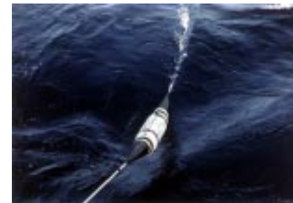
Unterwasserverstärker: 1-2 m Länge, 30-50 cm Breite, 300-500 kg, 40W, 0.5-1 Mio $, in bis zu 7000 m Tiefe.
