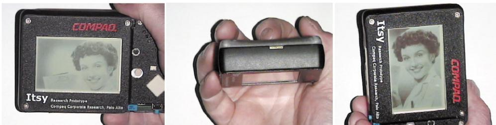
Abbildung 1.4: Durch Drehung des Geräts wird die Bildschirmausrichtung automatisch angepasst. [2]
