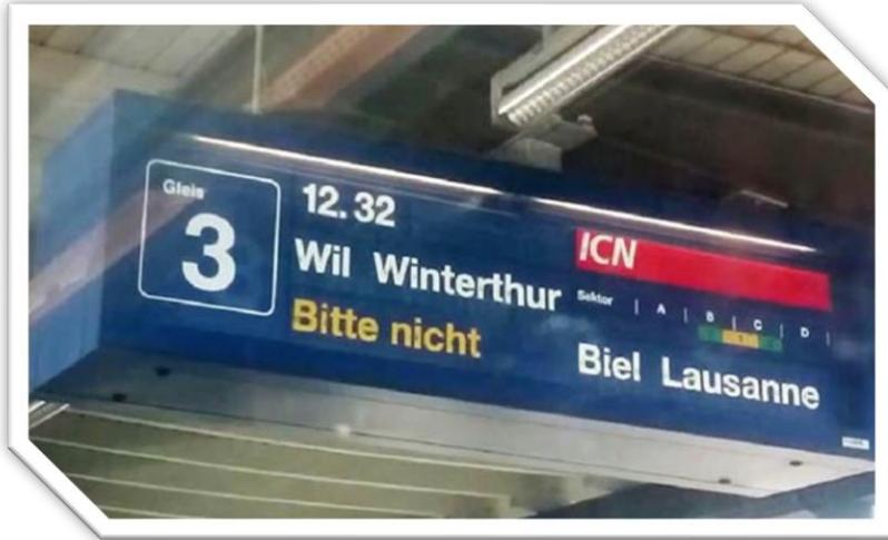
Die Aktualisierung der mehrteiligen mechanischen Anzeigetafel erfolgte erkennbar auf nicht-atomare Weise. Sah man im „falschen“ Moment hin, gewährte man einen unbeabsichtigten Zwischenzustand.
