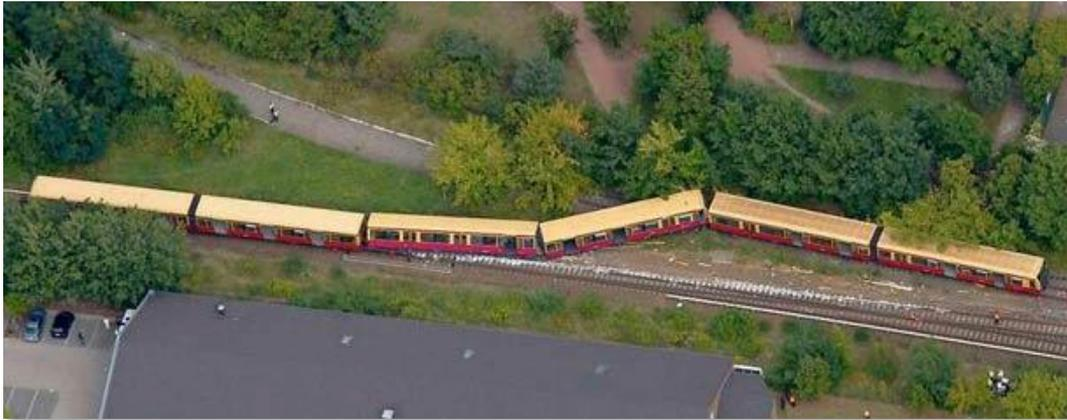
„Nach dem Befahren der Weiche 74 mit den ersten beiden Wagen, **lief die Weiche 74 unter dem fahrenden Zug vollständig in die Linkslage um**, wodurch die nachfolgenden Fahrzeuge in Richtung Stumpfgleis der Niederbarnimer Eisenbahn abgeleitet wurden. Dabei entgleisten der 3. und 4. Wagen des Zuges mit allen Radsätzen, und der 3. Wagen kam in Schräglage. Der Triebfahrzeugführer setzte einen Notruf ab.
