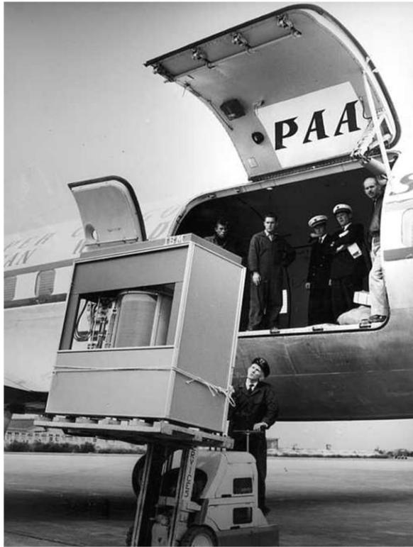
Lufttransport eines IBM 350-Magnetplattensystems („RAMAC – Random Access Method of Accounting and Control“). Es wurde 1956 angekündigt, wog ca. eine Tonne, konnte 5MB speichern und kostete 3200 US-Dollar Miete pro Monat. Direktzugriff auf externe Daten mit Disks anstelle des sequentiellen Zugriffs bei Magnetbändern stellte eine technische Revolution dar.
