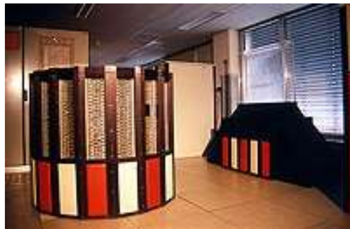
Cray 2S , Nov. 1988 - Mai 1994: 4 Prozessoren; 2 GFLOPS; 1 GB Hauptspeicher
