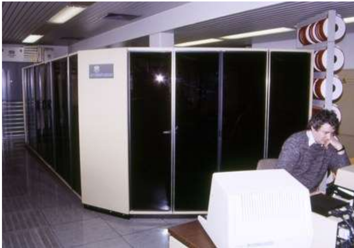
Cyber-205 , bis März 1989: 1 Prozessor; 0.2 GFLOPS; 0.032 GB Hauptspeicher
