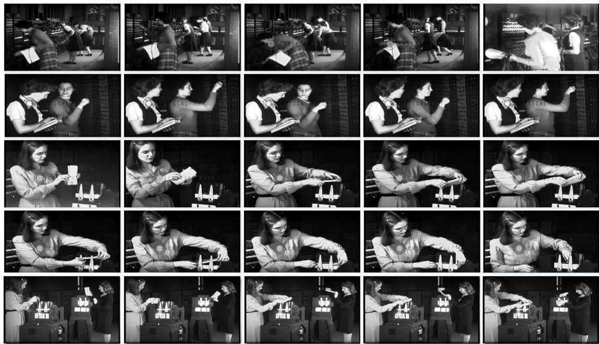
“Set up of a problem on the ENIAC” mit Schaltkabeln, Schaltereinstellungen und Lochkarten
