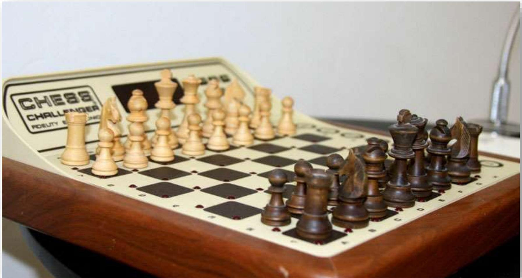
Ab 1977 (erstes Produkt: *Chess Challenger 1* mit einem 8-Bit-8080-Mikroprozessor, 2MHz Taktfrequenz, 2kB ROM, 256 Byte RAM; diverse verbesserte Nachfolgemodelle bald danach)
