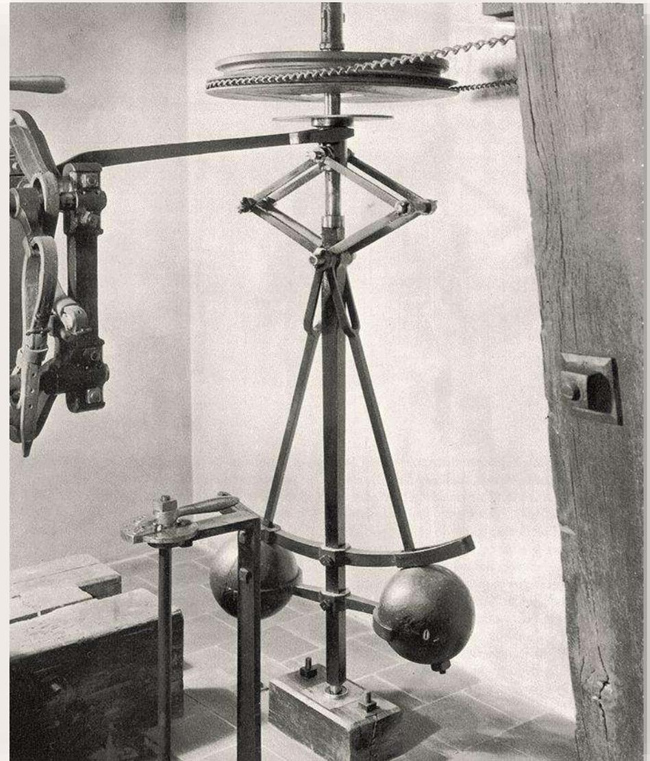
Fliehkraftregler der Wattschen Dampfmaschine von 1788. Bild: Deutsches Museum
