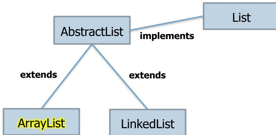
Das **Interface „List“** spezifiziert Methoden für den Zugriff auf Listen (**Einfügen** und **Entfernen** von Elementen) sowie Methoden für komplexere Operationen (z.B. **Suche** in einer Liste)
