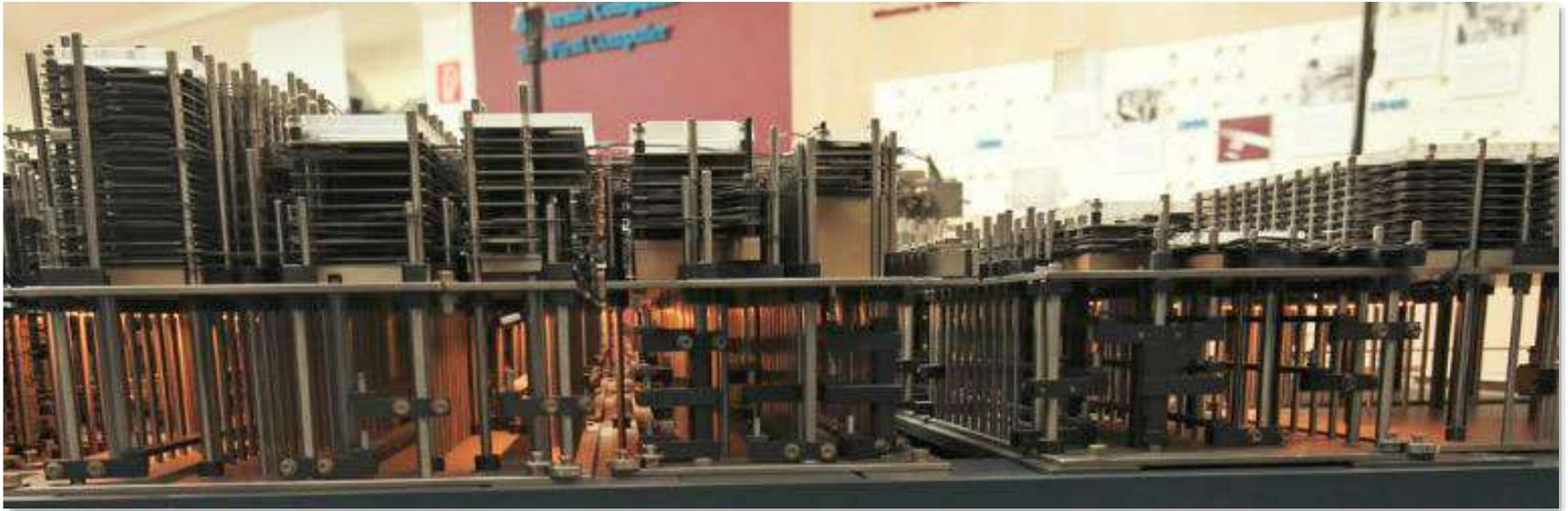
**Nachbau der Z1** (Bild: Raúl Rojas) von Zuse selbst vorgenommen; das Original wurde bei einem Bombenangriff auf Berlin im Dezember 1943 zerstört. Rechts die acht Speicher-ebenen, links die zwölf Ebenen für den Prozessor. Im unteren Teil das Hebelwerk, das den Takt an alle Maschinenkomponenten weiterleitet. „Im einzigen überlebenden Video der laufenden Maschine erweckt dies den Anschein von beweglichen Teilen eines Webstuhls. Allerdings webte diese Maschine Zahlen“ [Rojas]
