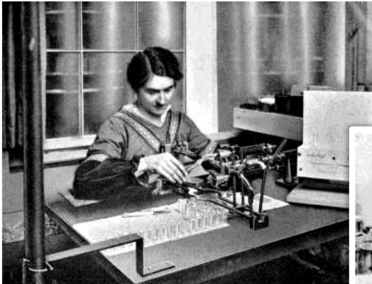
Die erste Andeutung der entstehenden Röhre ist ein etwa 5 cm langes Stück Glasrohr, das an einer Anschlagvorrichtung abgeschnitten, dann an einer zweiten drehbankähnlichen Vorrichtung in der Gasflamme an einem Ende zu einem sogenannten Teller erweitert wird.
