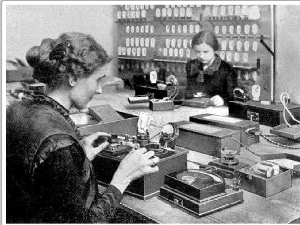
Jede einzelne Röhre wird einer Vakuummessung unterzogen.
