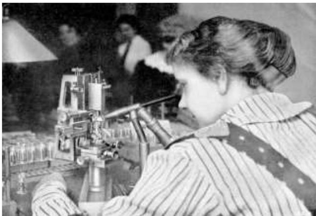
*Biegen, Aufsetzen und Schweißen der Elektroden*
