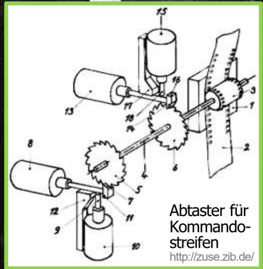
Rechts: Abtaster für das Hauptprogramm; links: Abtaster für ein Unterprogramm als Schleife
