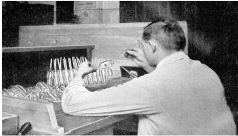
*Einschmelzen des Fußes in den Kolben*
