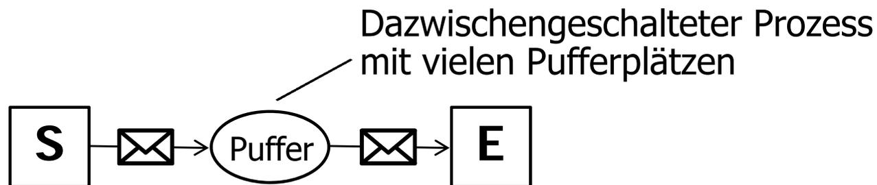
→ **Entkoppelung** von Sender und Empfänger
