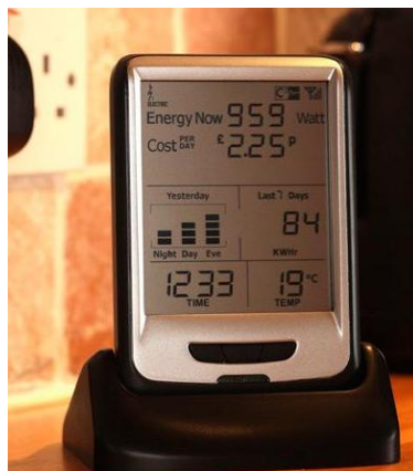
Abbildung 2: Envi, die zweite Generationen von Displays von Current Cost. Es zeigt Zeit, Temperatur und auch noch den momentanen Energieverbrauch sowie den der letzten paar Tage an [1].
