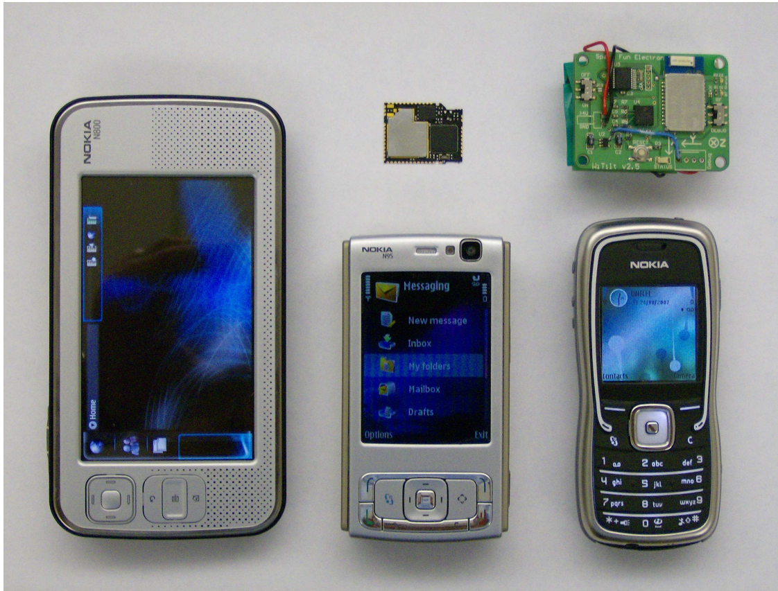
Abbildung 1: Von links nach rechts: Nokia N800 , Nokia N95 , Nokia 5500 Sport . Oben links: Moteiv Tmote Mini , oben rechts: Prototyp des BlueCel Chips
