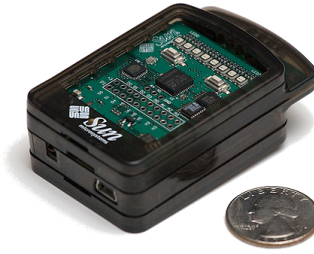
Abbildung 4: Ein Sun SPOT im Grössenvergleich mit einem amerikanischen Viertel-Dollar.
