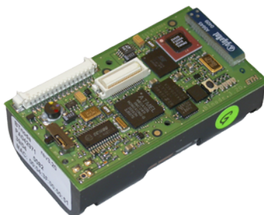
Abbildung 3: Der BTnode rev3 wurde an der ETH Zürich entwickelt und kann als generischer Sensorknoten in Sensornetzen eingesetzt werden. [1]
