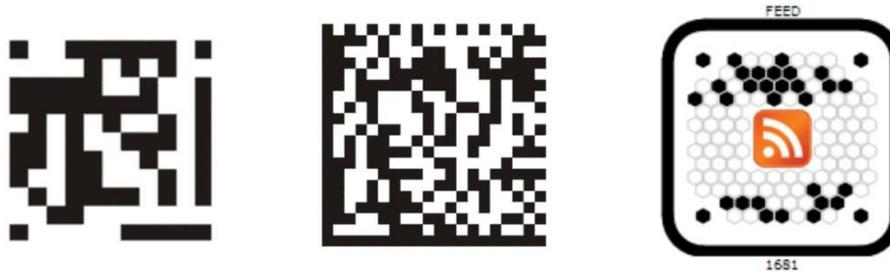
**Bild 3.** 2D-Codes. Visual code (links), DataMatrix (Mitte), BeeTag (rechts)
